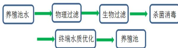
循环水养殖系统工艺流程基础框架图
