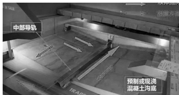
图7 法式V形刮板刮粪模式示意图
