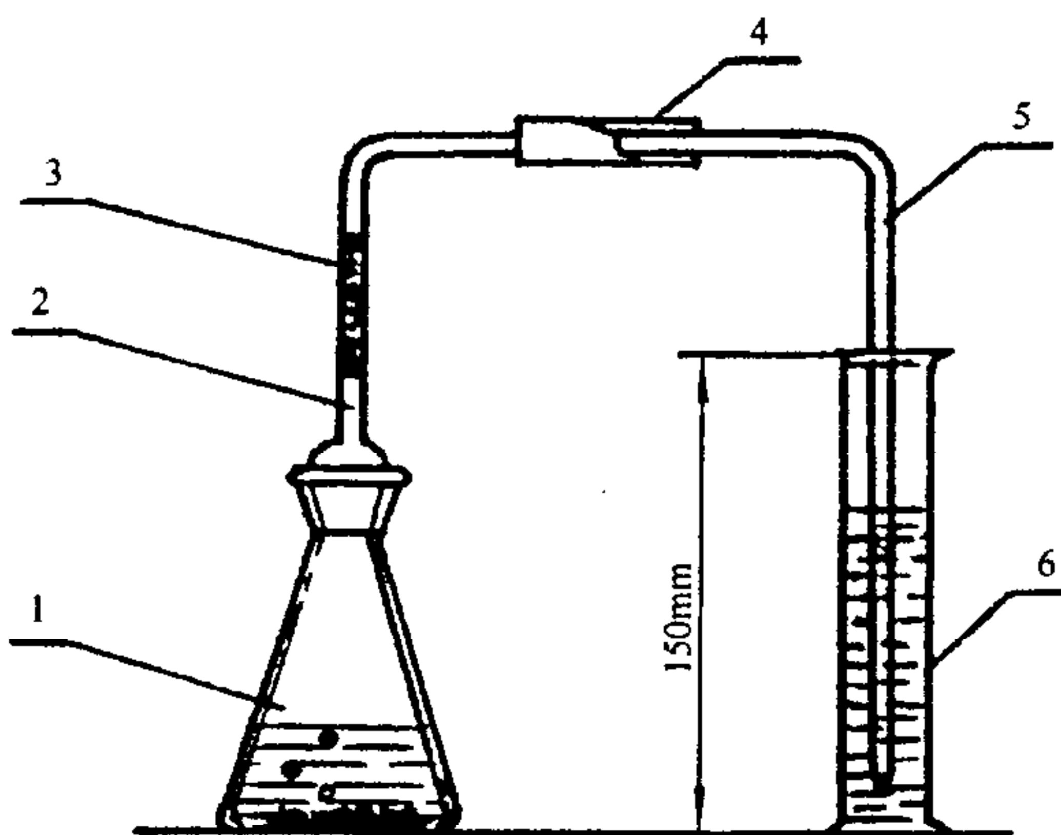
1—100mL 带磨口定砷瓶；2—导气管；3—醋酸铅棉花；4—胶管；5—尖嘴玻璃管；6—小量筒
