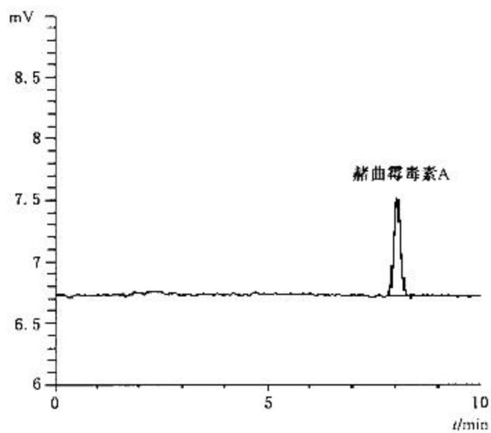
图 A.1 5.0  $\mu\text{g}/\text{kg}$  赭曲霉毒素 A 标准品的液相色谱图
